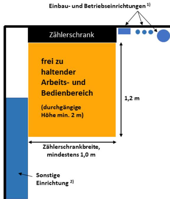
**Abbildung 3: Arbeits- und Bedienbereich vor dem Zählerschrank**
