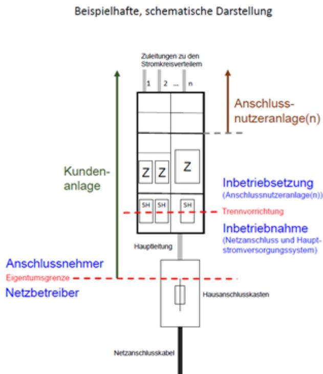
**Abbildung 1: schematische Darstellung der Begriffe Inbetriebnahme / Inbetriebsetzung sowie Kundenanlage / Anschlussnutzeranlage**
