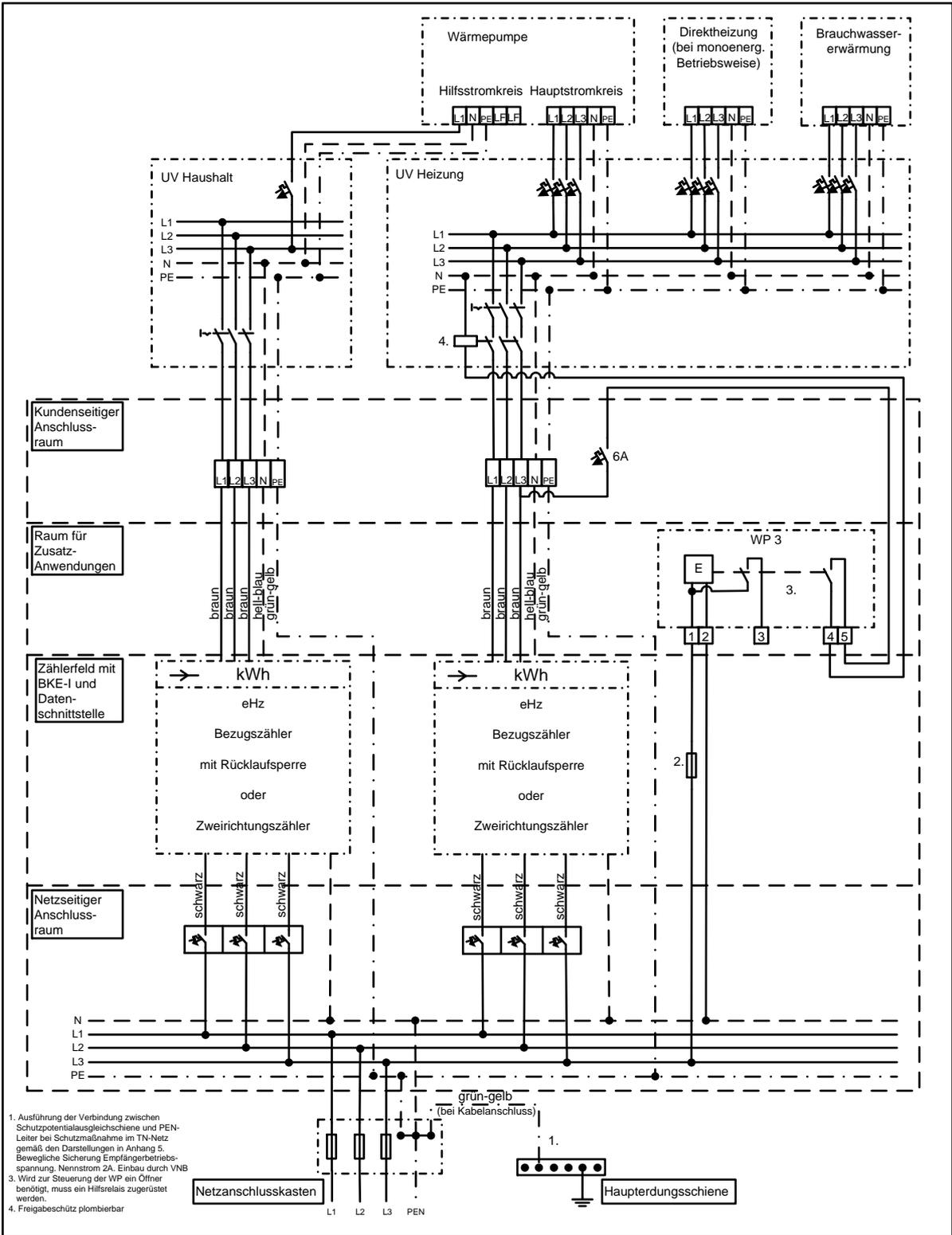
1. Ausführung der Verbindung zwischen Schutzpotentialausgleichschiene und PEN-Leiter bei Schutzmaßnahme im TN-Netz gemäß den Darstellungen in Anhang 5.
