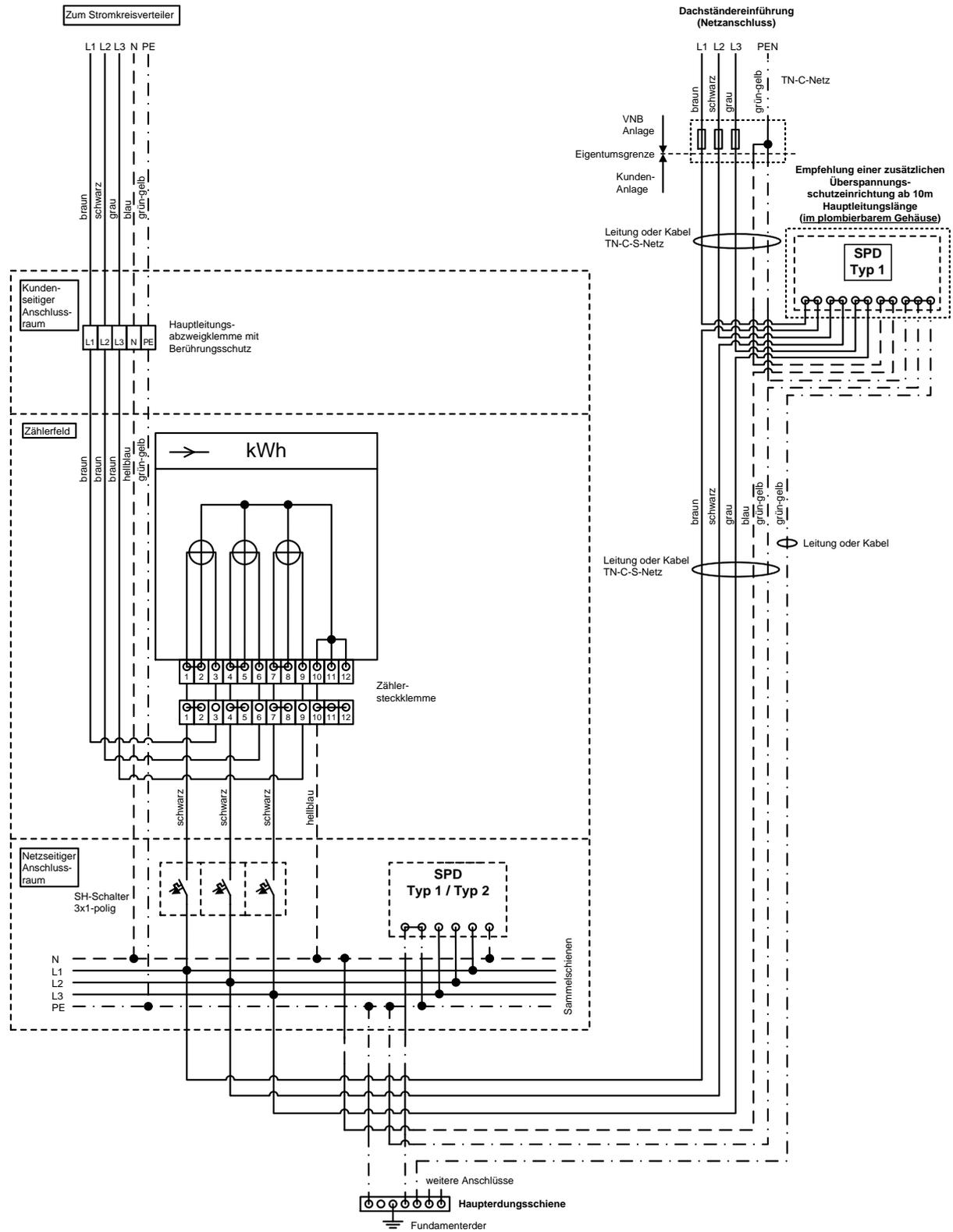
Bild 5.2 Anschlussschema Freileitungshausanschluss
